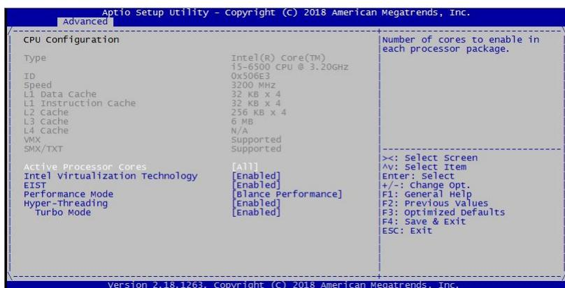
显示CPU的相关信息。注意，CPU的相关信息跟平台所安装的CPU有关，不同系列的CPU所显示的信息不同。
