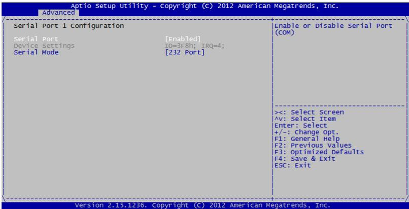
**\* Serial Port1~6（实际串口个数以主板的配置为准）**
